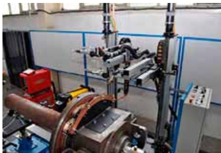
Vítaný exponát posledného MSV Nitra – Eurowelding: modulárny zvärací systém Autoweld 7000 MIG/MAG Quatro pre bezdeformačné automatizované zváranie stehovaných nosníkov štvorico horákov súčasne.
